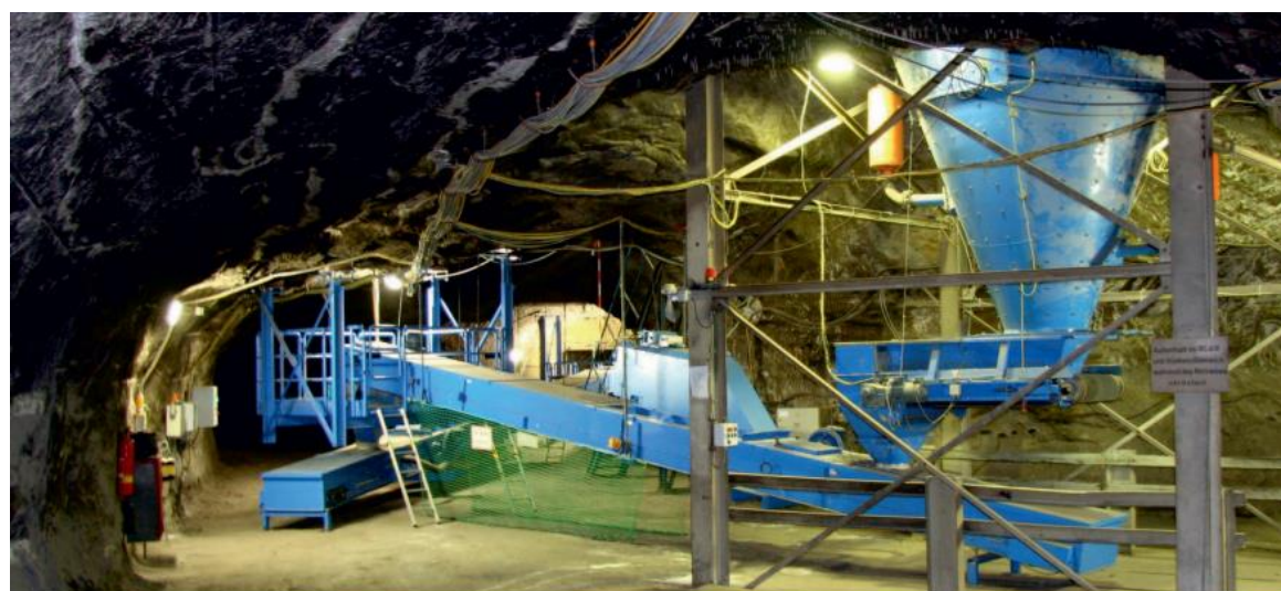
Рис. 5. Немецкий опыт шахтного захоронения остеклованной диоксиновой пыли из дымовых газов: слева — транспортировка материала на закрытых конвейерных лентах от шахтного ствола к грузовикам; справа — в соляной шахте электроэкскаватор перегружает доставленную грузовиком остеклованную пыль из перегрузочного бункера в шахтную технику для транспортировки на большую глубину. [Prognos AG, Birnstengel 2012]
