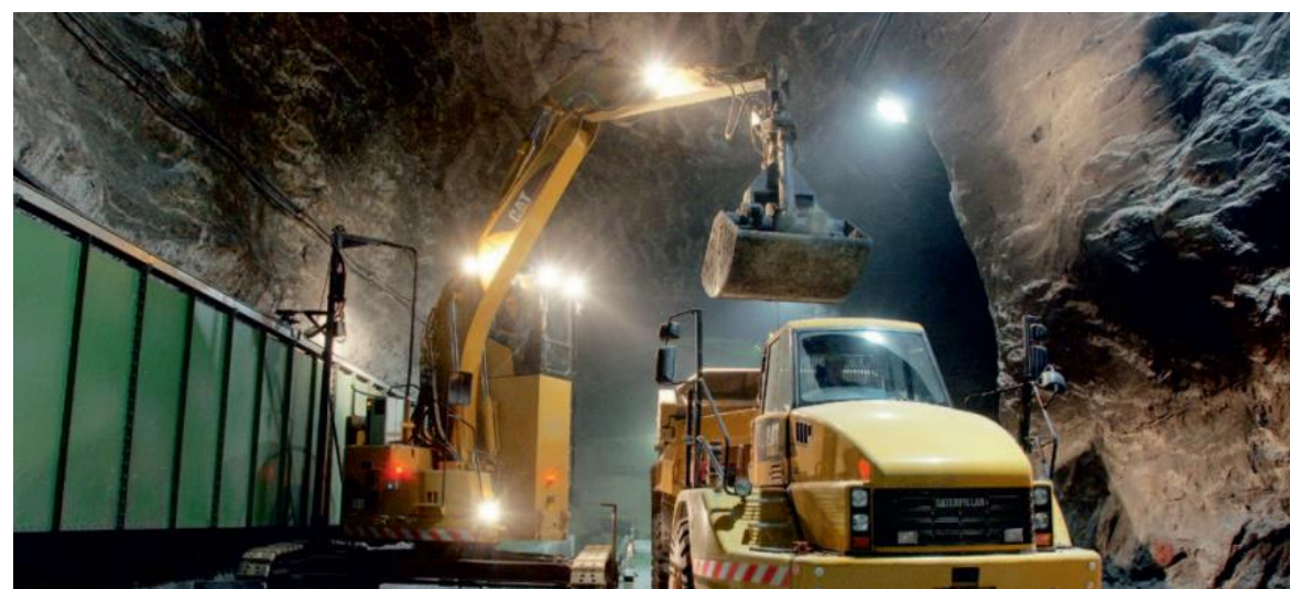
Рис. 5. Немецкий опыт шахтного захоронения остеклованной диоксиновой пыли из дымовых газов: слева — транспортировка материала на закрытых конвейерных лентах от шахтного ствола к грузовикам; справа — в соляной шахте электроэкскаватор перегружает доставленную грузовиком остеклованную пыль из перегрузочного бункера в шахтную технику для транспортировки на большую глубину. [Prognos AG, Birnstengel 2012]
